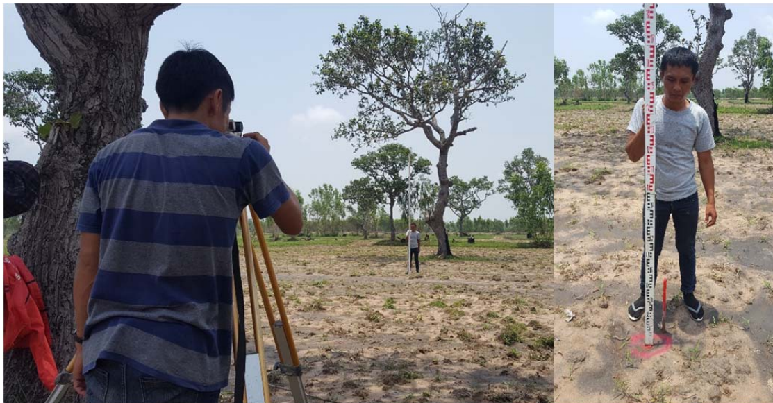
รูปที่ 8 การให้ค่าระดับสำหรับการปรับหยาบ
